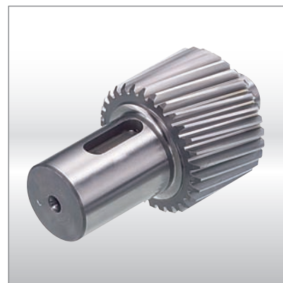
Helical gear design 기어 맞물림이 평기어의 2배 이상인 Helical gear 적용으로 동작 소음을 최소화하고 고출력, 저소음, 저백래시를 실현하였습니다.
