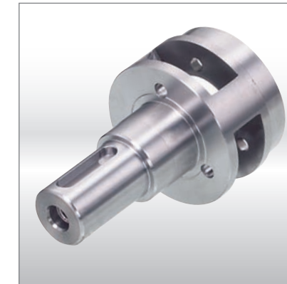
Integrated planetary arm bracket Planetary arm bracket과 출력 Shaft는 일체형 구조로 한번에 정밀 가공되어 비틀림 강도와 정밀도를 향상 시켰습니다.
